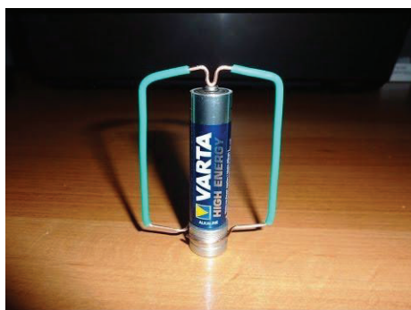
Рисунок 1 – Мотор из батарейки, магнита и проволоки
