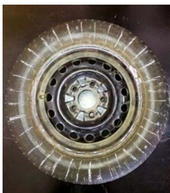
Рисунок 2 – Движитель R14 легкового автомобиля с нанесенными метками
