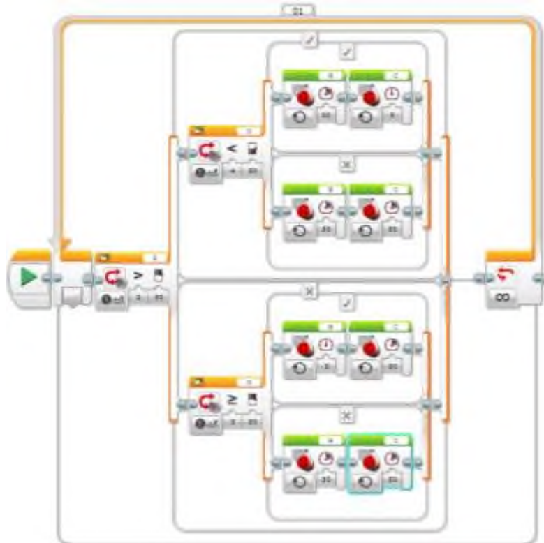
Сурет 2. Екі түсті сенсоры бар роботтың «Толқын» алгоритмі бойынша сызық бойымен жүру программасы
