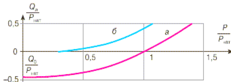
2 сурет Реактивті қуатқа берілетін активті өтелмеген (а) және өтелген (б) ұзындығы 400 км 500 кВ ЭЖ тәуелділік қисығы
