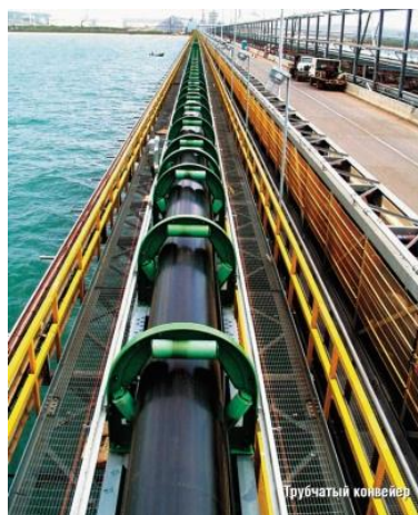
Рисунок 2. Трубчатый конвейер Германская фирма «Koch»
