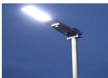
Рис.2 Фонарный столб, оснащенный датчиком
